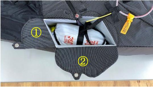
パラシュートをコンテナに写真のように挿入します。
