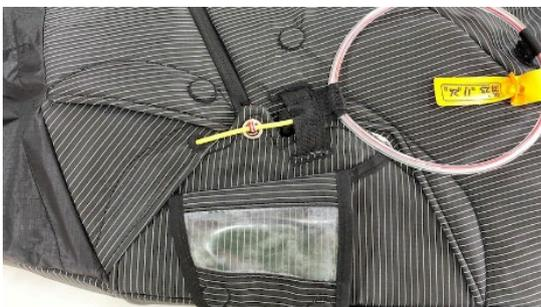
レスキューグリップのテープを、グリップ固定用のポケットに2ヶ所、挿入し、グリップを固定します。
