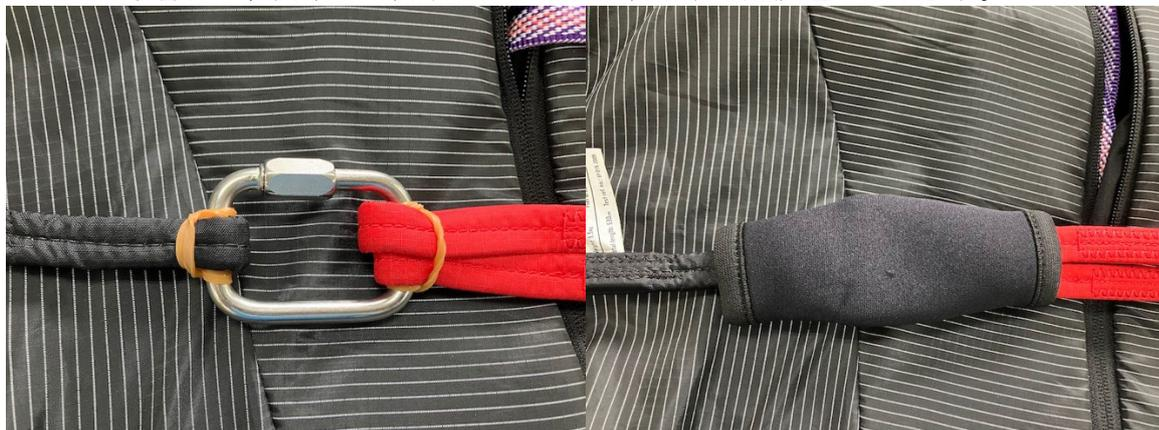
ブライダルコード同士を直接接続した場合、開傘時にブライダルコードが摩擦熱でコード溶け、切断する可能性があります。
